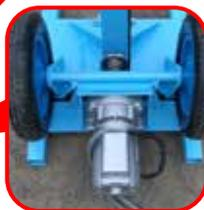
滑車を取り付け、モータとワイヤでドリルヘッド部の引上げをサポート
