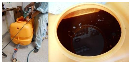
写真2 ヤマブドウ残渣溶出液の注入状況
